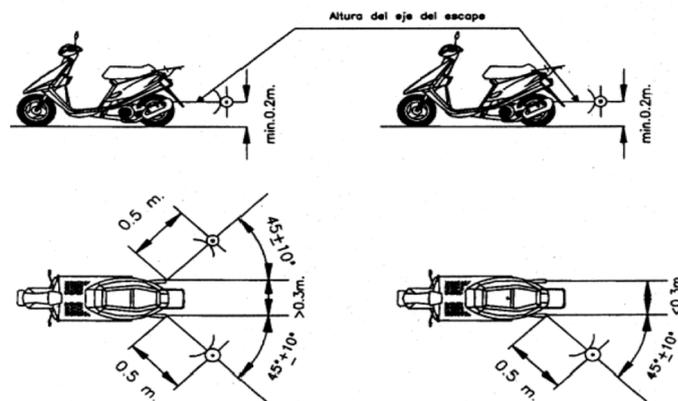
Figura 1. Posiciones para el ensayo de las motocicletas paradas
